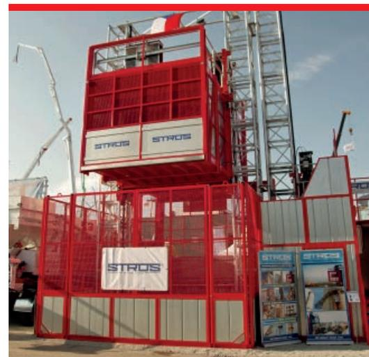
Строительные подъемники используются при строительстве с высокими требованиями к транспортировке пассажиров и материала, на стройках высотных зданий и мостовых опор. Подъемники сконструированы и изготовлены, чтобы работали длительно и надежно. Подъемник предназначен для работы на двух мачтах.
